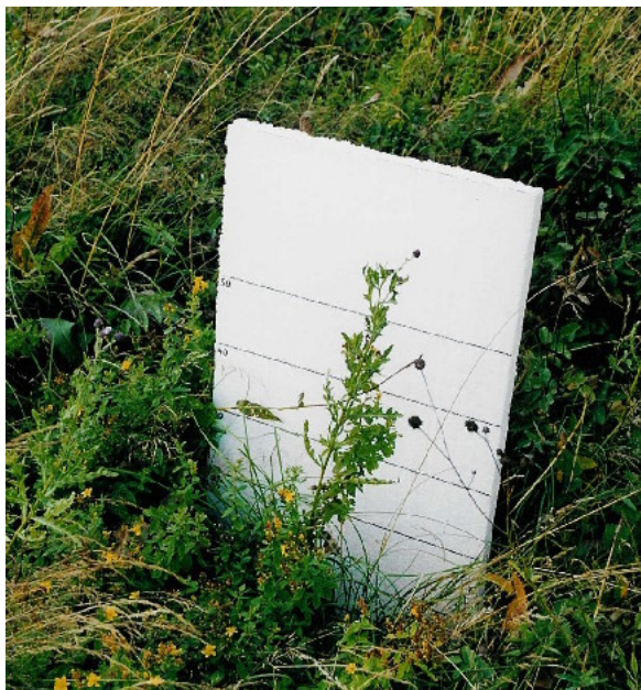
Abb. 10: Präparierte Styropor®-Tafel zur Aufnahme der horizontalen Vegetationsdeckung. In den Höhen 5, 10, 20 und 30 und 40 cm über dem Boden befinden sich schwarze Linien als Markierung.
